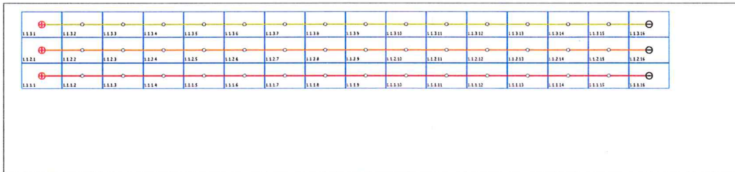
Pohled střecha – rozložení stringů a elektrické pospojování panelů
